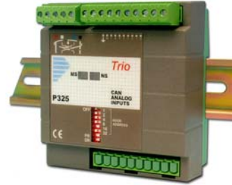
P325 - CAN-8 Analog Inputs
